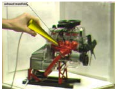
Слика 7: Ознаките на деловите на моделот на мотор се појавуваат кога корисникот покажува кон нив.
